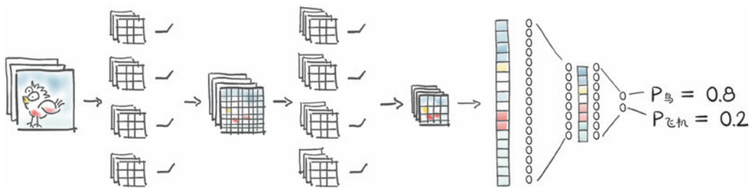
图 8.9 典型卷积神经网络的形状，包括我们正在构建的模块。将一幅图像输入一系列卷积和最大池化模块，然后将其拉成一维向量，并输入全连接模块中
